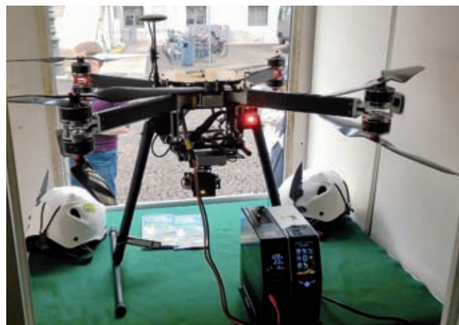
Drone dotato di telecamera e geolocalizzatore
